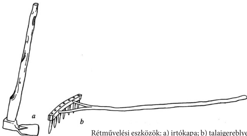
Rétművelési eszközök: a) irtókapa; b) talajgereblye
